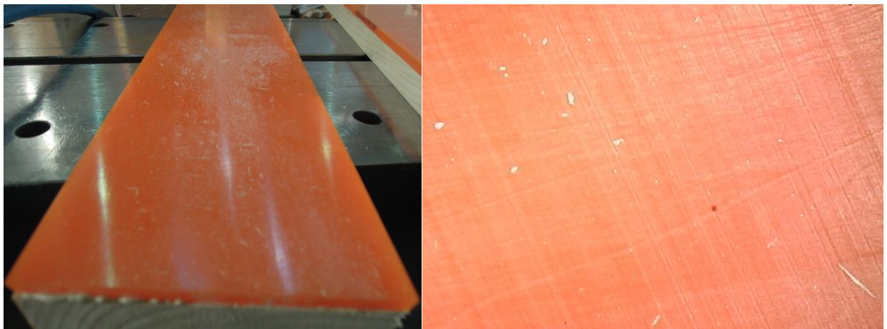
Abbildung 4.9: links: Materialabbau bei der Prüfung V70FH12F, rechts: die 200-fache digitale Vergrößerung
