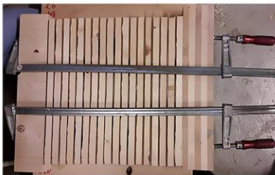
Abbildung 3.24: Befestigung der Schalldämmbänder (Grundkörper)
