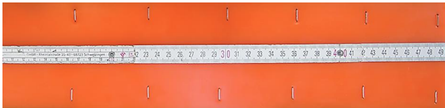
Abbildung 3.17: Anordnung der Klammern
