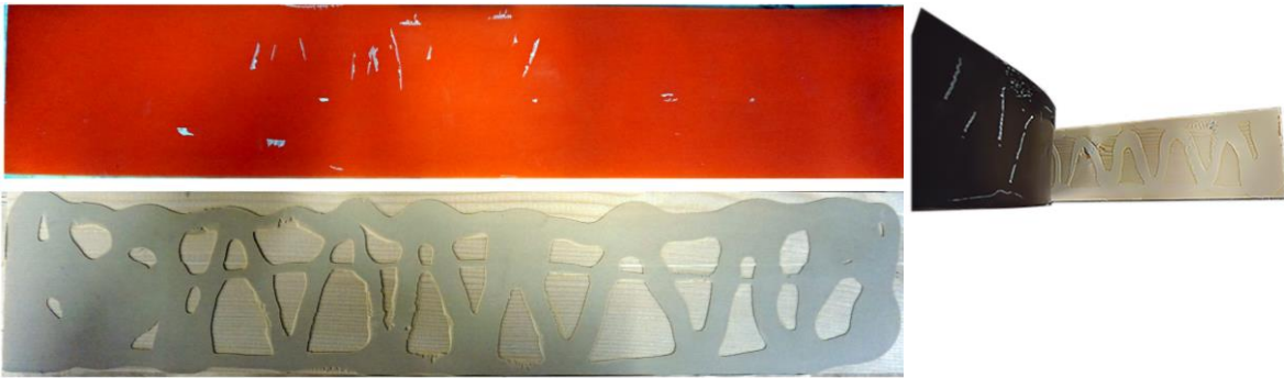
Abbildung 3.22: Versagen des Verbundes zwischen Kleber und Schalldämmbänder
