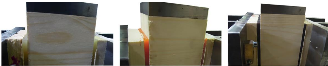
Abbildung 3.23: Festhaltung der Schalldämmbänder (V035FH12S12; V070FH12S13; V090FM12S14)
