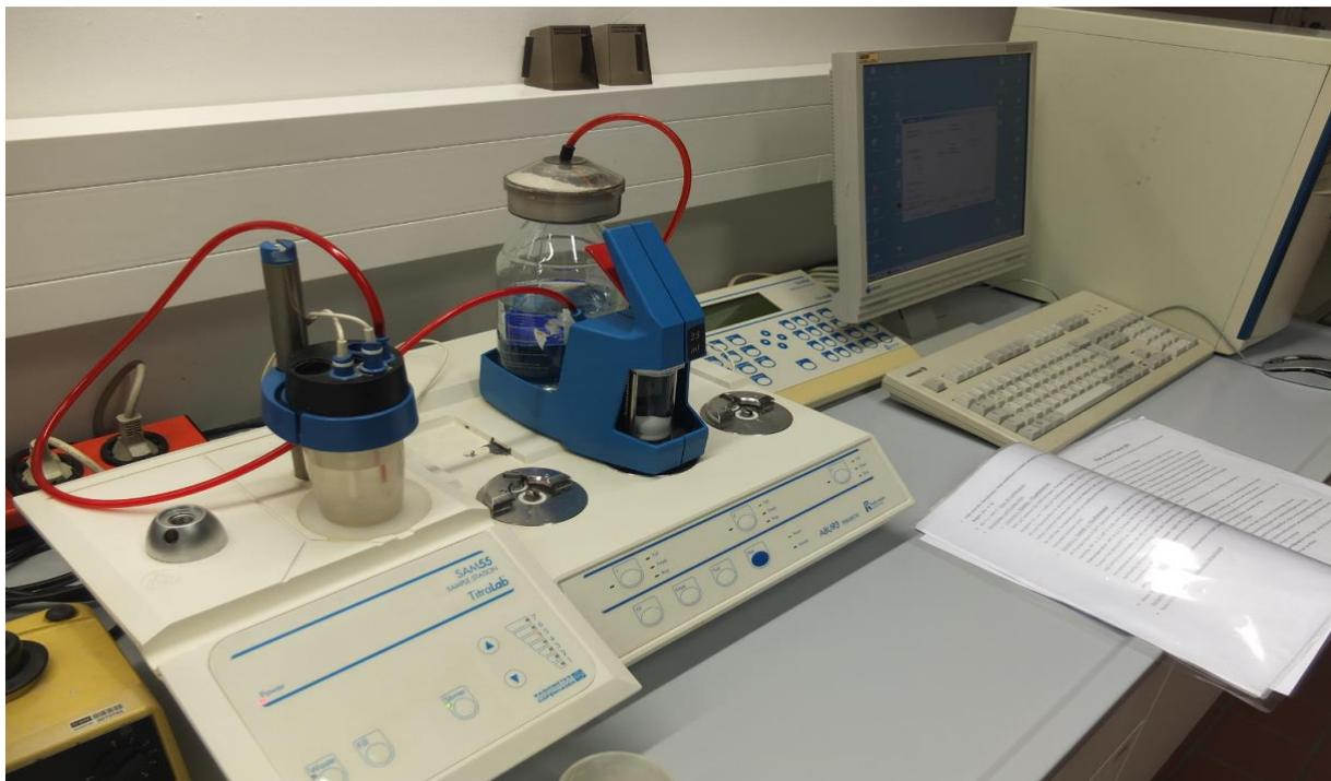
Abb. 4-3: Säurezahlbestimmung
