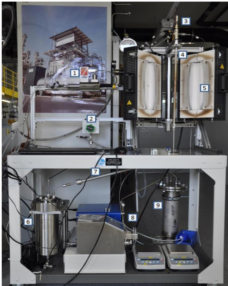
Abb. 3-1: Aufbau der Anlage [6]: (1) Massendurchflussregler, (2) Druckregelventil, (3) Thermoelement, (4) Rohrreaktor, (5) Heizmantel, (6) Produktbehälter, (7) Kühler, (8) Hochdruckpumpen, (9) Expansionsbehälter
