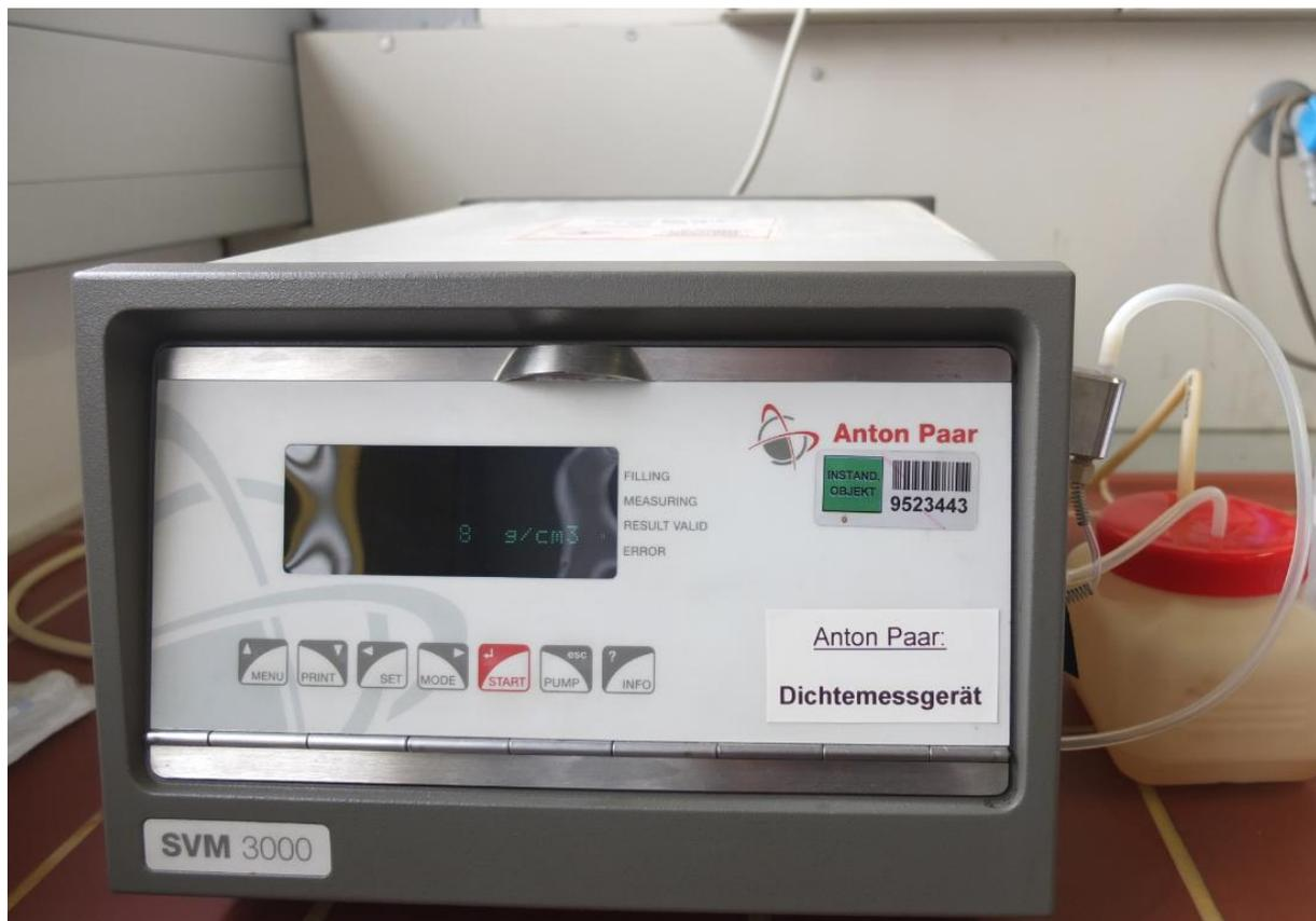
Abb. 4-2: Dichtemessgerät
