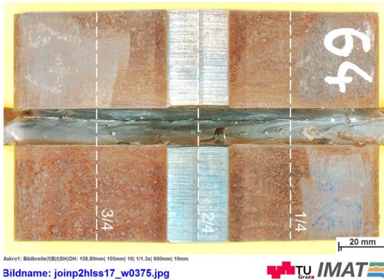
Abbildung 74 Draufsicht von Versuch mit optimiertem Parameterset
