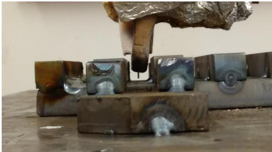
Abbildung 47 Vorderansicht der Positionierung von Brenner und Magnet im Engspalt
