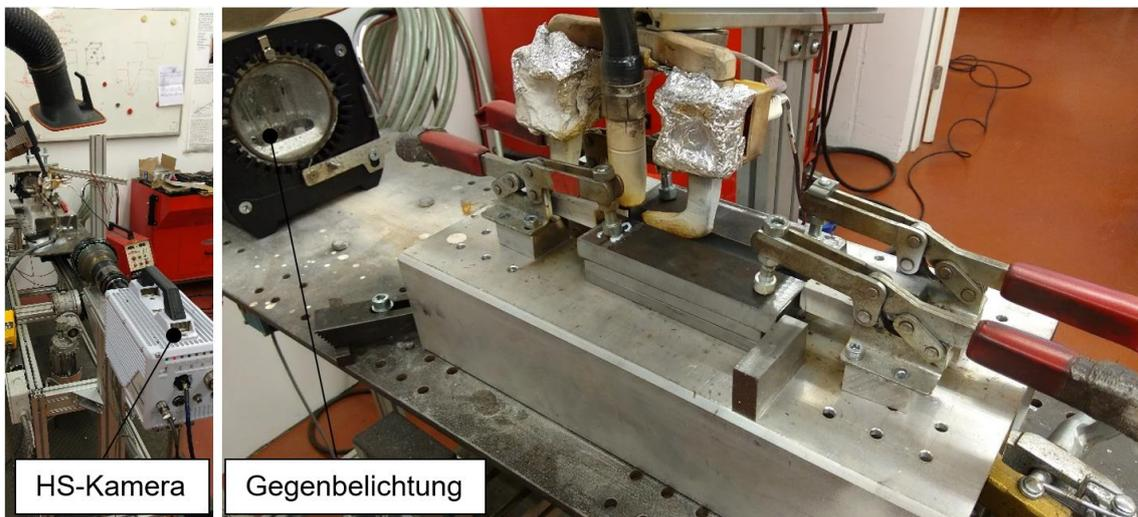
Abbildung 61 Versuchsaufbau mit Hochgeschwindigkeits-Kamera
