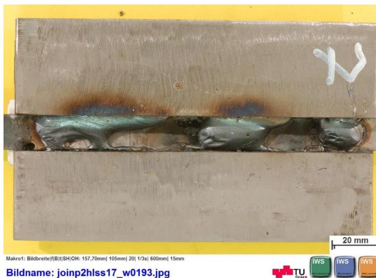
Abbildung 62 Draufsicht der Versuche mit durchgeschmolzenem 1,5 mm Einlegeblech
