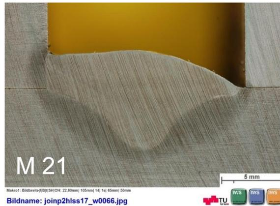
Abbildung 50 Makro-Querschliff der Referenznaht bei gleichen Parametern ohne magnetische Ablenkung und M 21; Adler Ätzung
