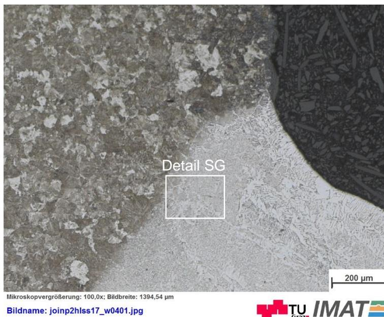
Abbildung 82 Detail Übergangsbereich WEZ – SG; 100-fache Vergr.; Nital Ätzung
