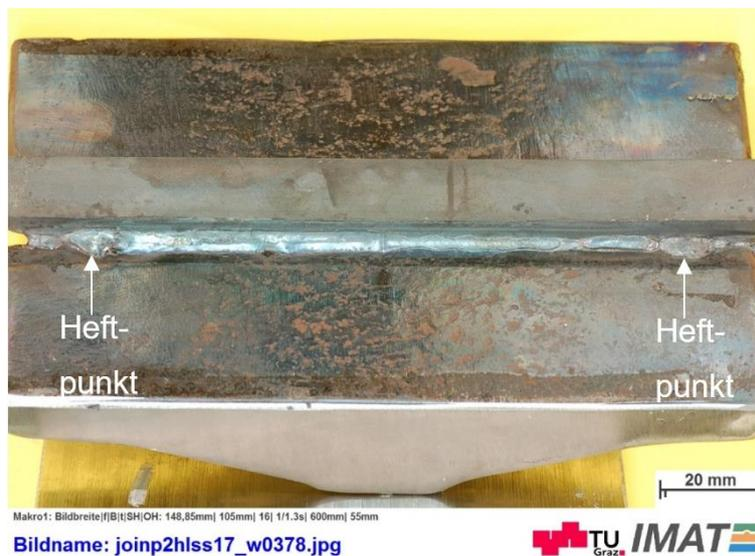
Abbildung 75 Linke Wurzel mit Heftpunkten
