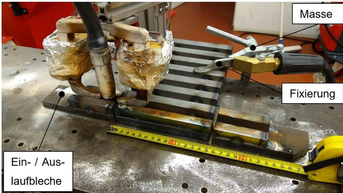
Abbildung 46 Versuchsaufbau der Versuchsserie 1 „Rippen“
