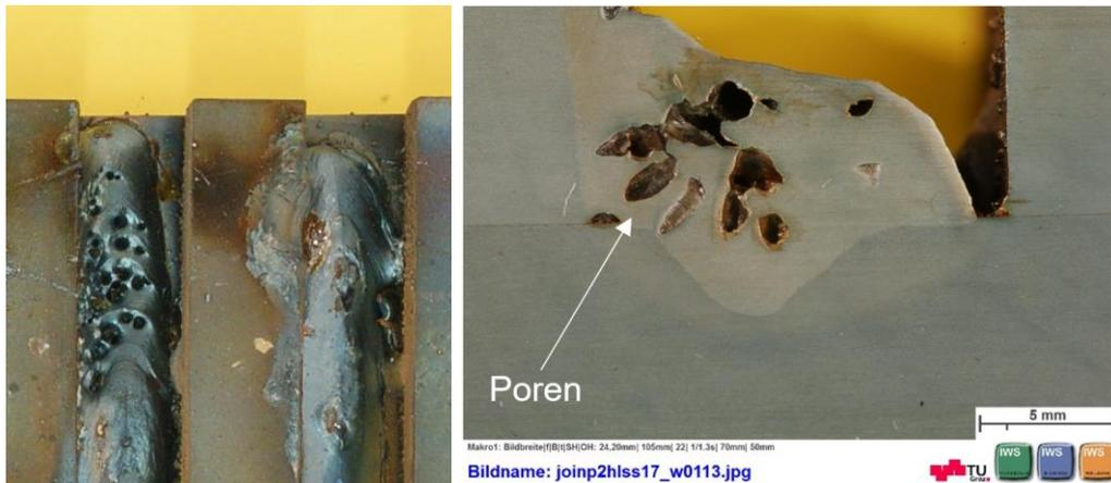
Abbildung 55 Versuchsserie mit Überschlügen; Draufsicht (li.); Makro-Querschliff; Adler Ätzung (re.)
