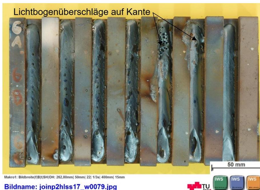
Abbildung 54 Draufsicht der Versuchsserie mit Überschlägen
