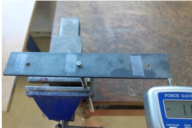
Abbildung 6-11: Drehmomentversuch über Kraftmessung
