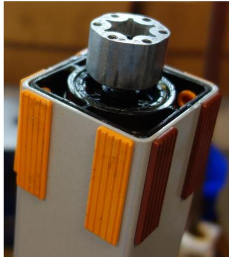
Abbildung 3-15: Antrieb mit Mittenrohradapter in der Säule verclippt
