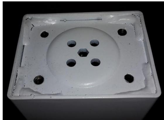
Abbildung 4-1: Antrieb mit Sechskantverbindung ohne Adapter
