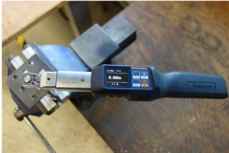
Abbildung 6-12: Drehmomentmessung für die zweite Prototypengeneration
