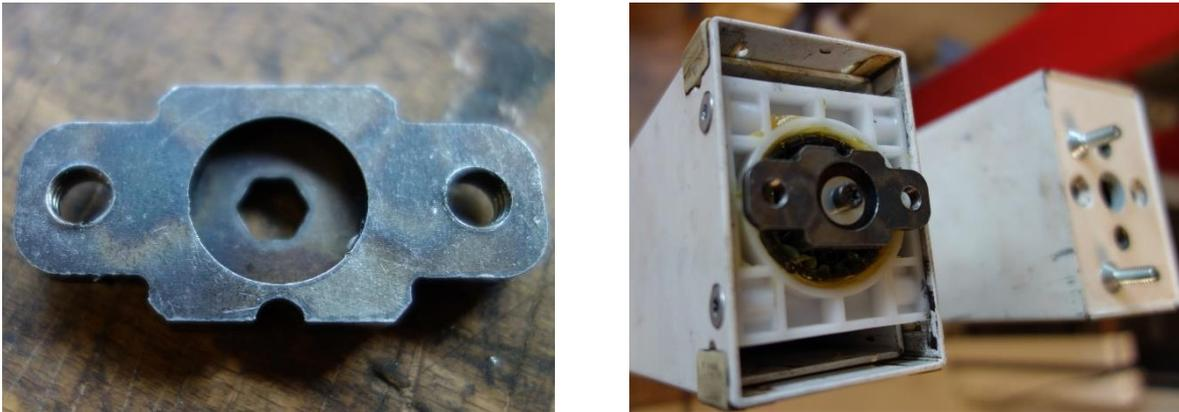
Abbildung 4-4: Spindelanbindungssystem für eine einfachere Montage am europäischen Markt
