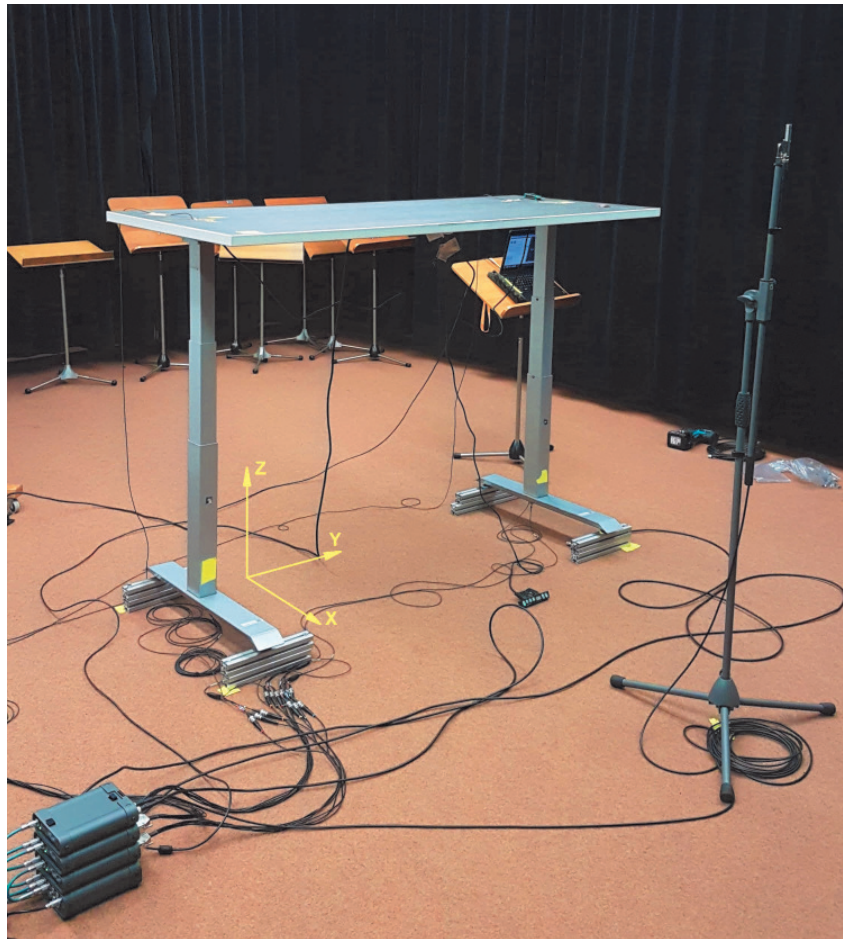
Abbildung 7.15: Messaufbau mit Referenzmikrofon im Tonstudio der TU Graz.
