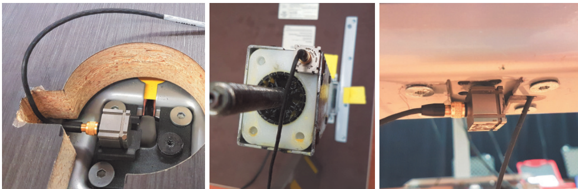
(b) KEP - schwarze Schrauben zwischen Antrieb und Aufnehmerplatte (Antrieb oben)
