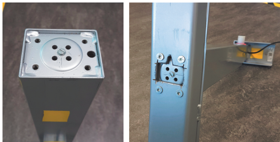
(e) direkte Verschraubung zwischen Spindel und unterem Säulenelement (f) Verschraubung zwischen Tischfuß und unterem Säulenelement
