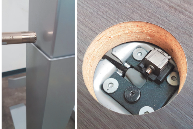
(b) Freiraum zwischen Säulenelementen (c) Verschraubung bei oberem Säulenelement
