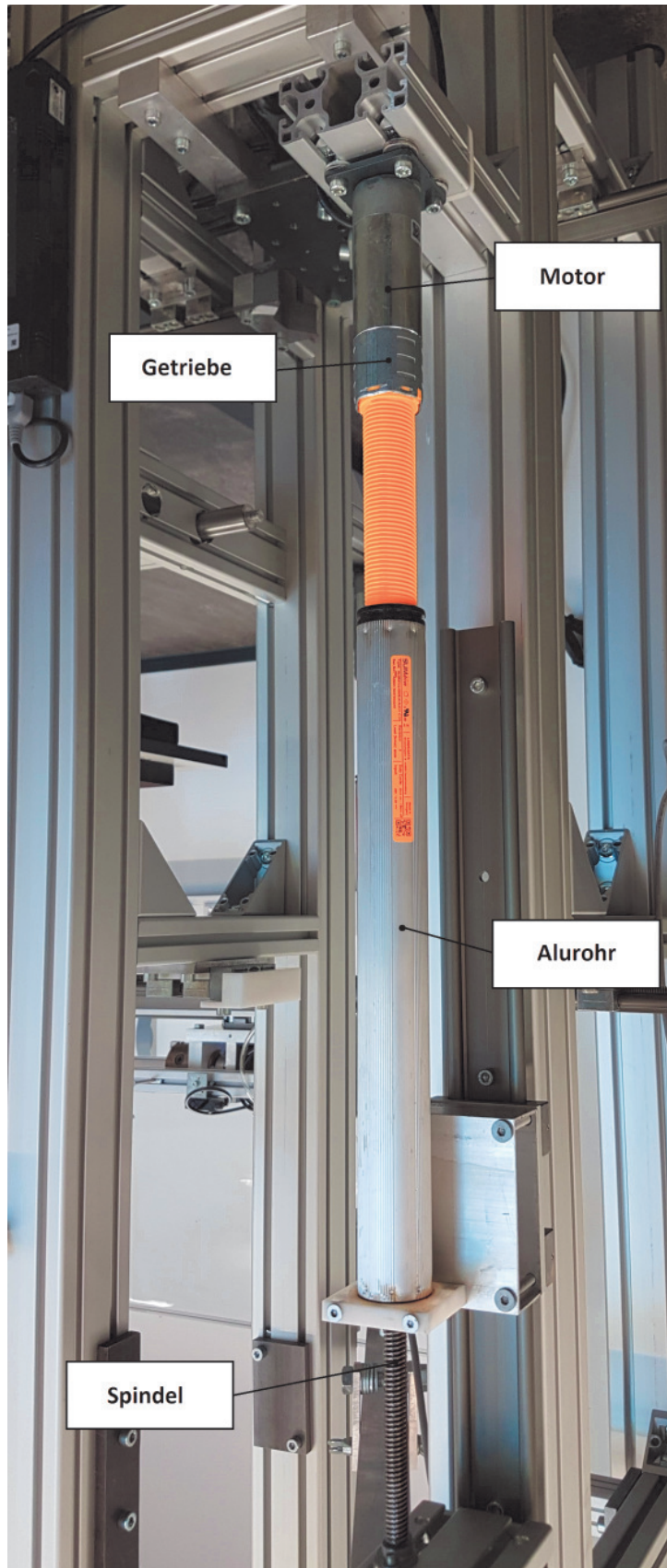
Abbildung 4.9: Definierte Messpositionen des ausgebauten Antriebes (Prüfstand). Das feste Ende befindet sich hier oben beim Motor.
