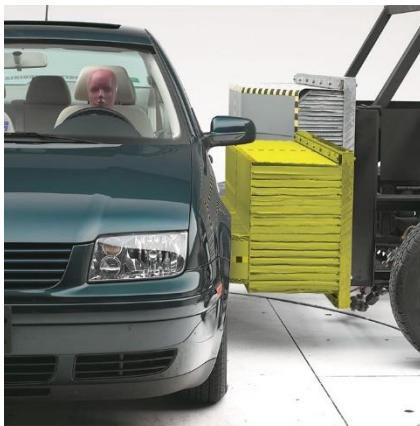
Abbildung 3-2: Relevante Lastfälle a: B-Säule im IIHS Sidecrash [18] b: Luggage Retention ECE R17
