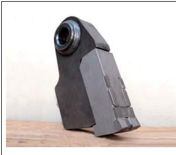
Abbildung 3.4-18: Terex Schlegel mit Wechselspitze 131
