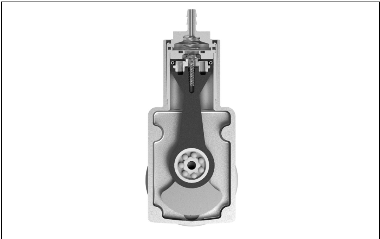
Abbildung 28: Schnittdarstellung des CSI durch den Kompressionsraum 127
