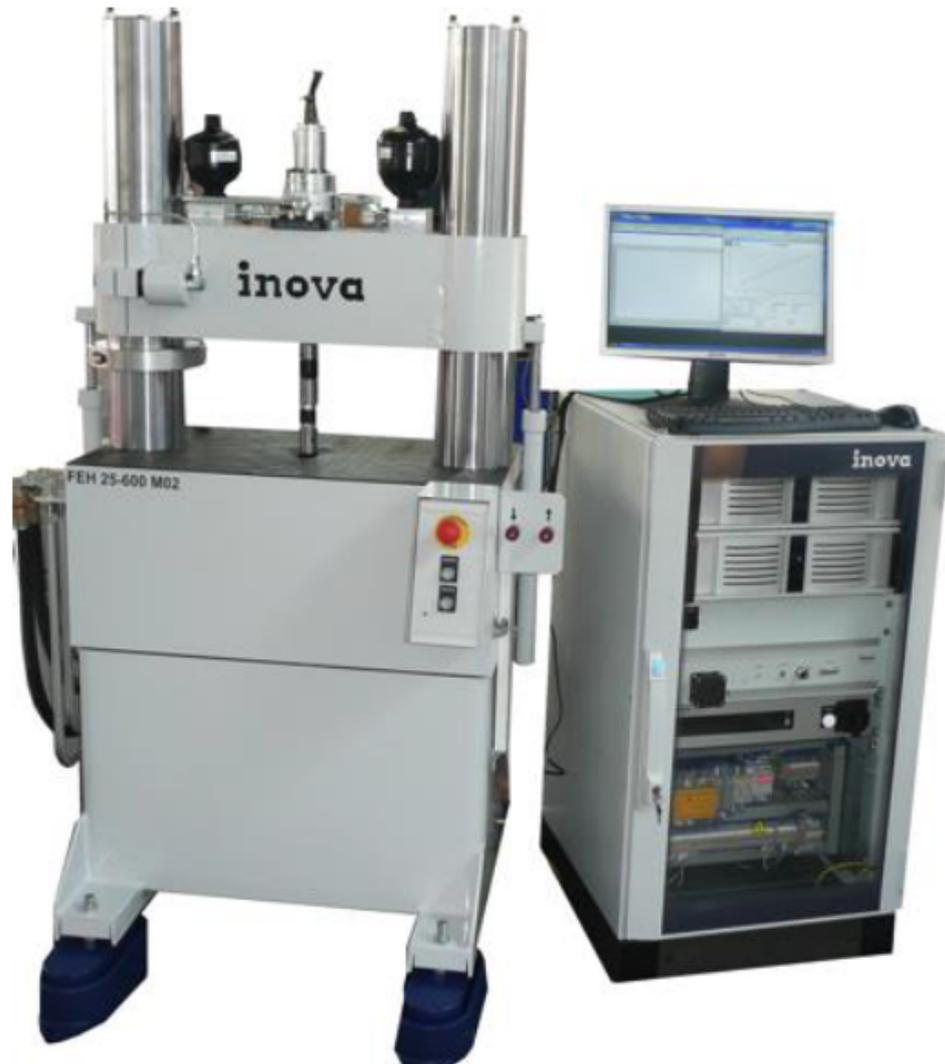
Abbildung 1.1.: Prüfstand zur Bestimmung der dynamischen Steifigkeit in axialer Richtung
