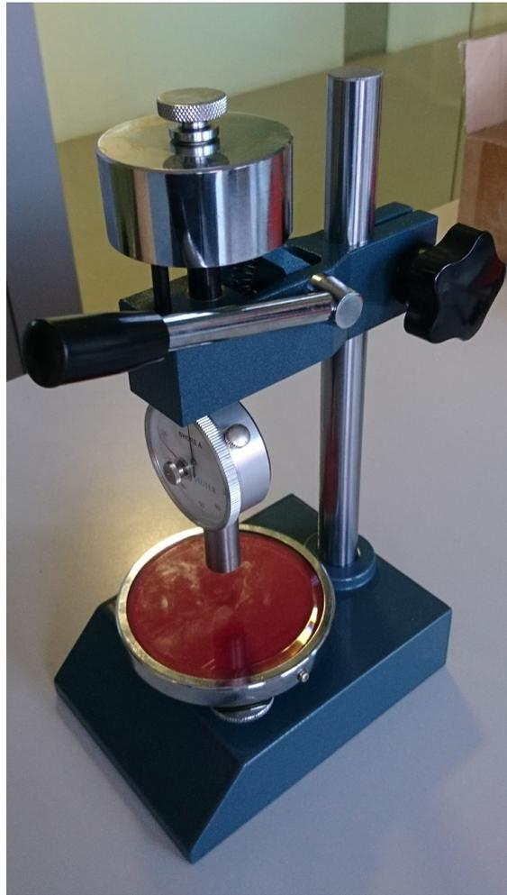
Abbildung 2.11.: Prüfstand zur Bestimmung der Shore-Härte (A-gewichtet)
