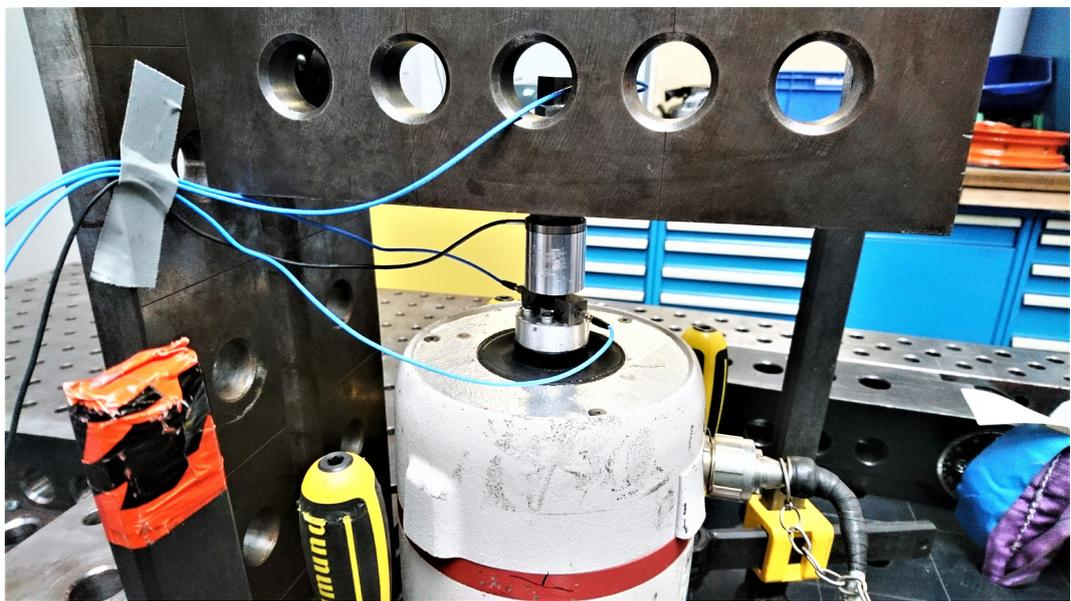
Abbildung 3.8.: Aufbau und Sensorpositionen des direkten Messverfahrens zur Bestimmung der dynamischen Steifigkeit von Silentblocks
