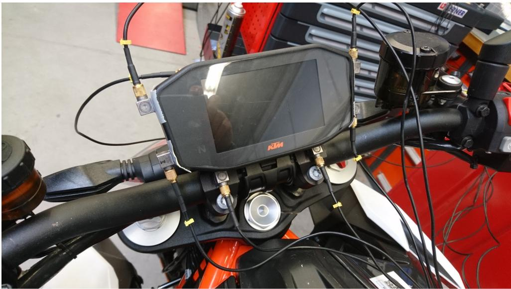
Abbildung 5.1.: Tacho der Superduke R mit montierten Beschleunigungssensoren
