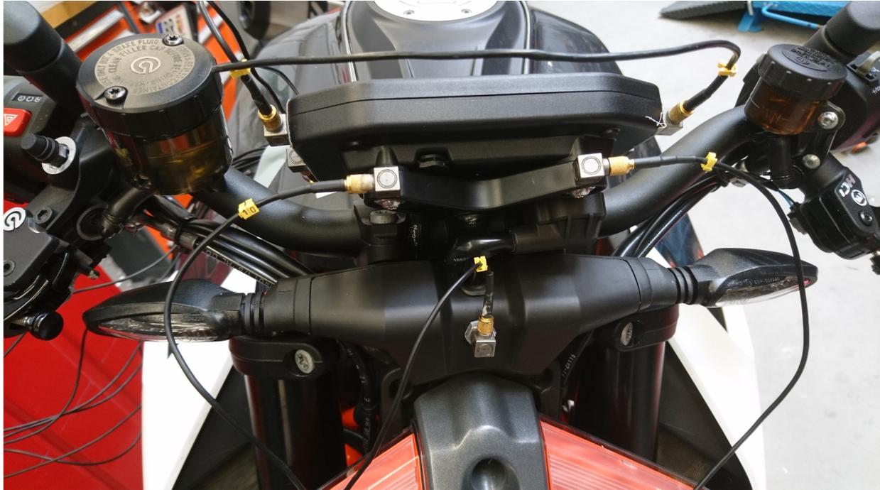
Abbildung 5.2.: Tacho der Superduke R mit montierten Beschleunigungssensoren in der Rückansicht
