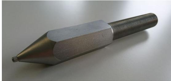
Abbildung 3.4.: Metallkegel zur Minimierung von Nebenwegübertragung
