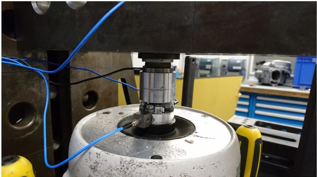
Abbildung 3.19.: Aufbau und Sensorpositionen des direkten Messverfahrens zur Bestimmung der dynamischen Steifigkeit des Rundgummis in axialer Richtung
