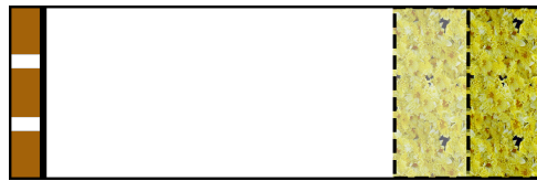
Abbildung 4.28: Schematischer Schichtaufbau zur Messung von Kombinationen aus Absorbermaterial mit unterschiedlicher Strömungsresistenz \Xi unter Einhaltung eines Luftspalts unmittelbar nach der Lochplatte.
