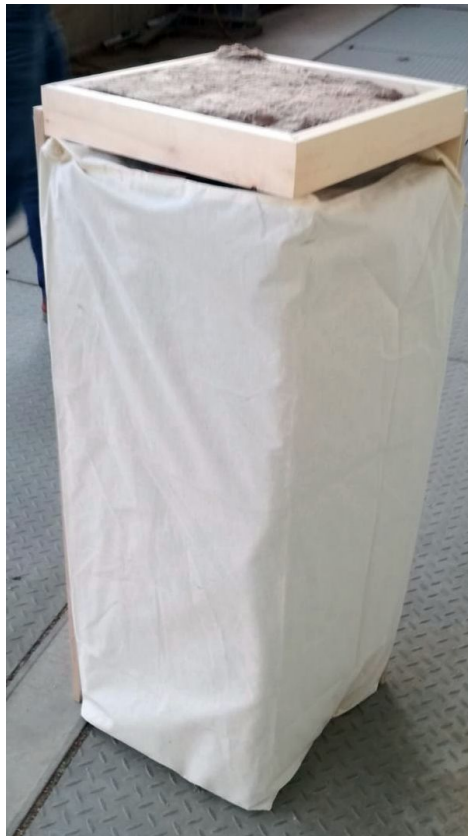
Abbildung 3.7: 100 cm Kantenabsorbermodul gefüllt mit Absorptionsmaterial. Innerhalb des Moduls befindet sich die Mineralwolle in einem Stoffsack, oben im Rahmen wurde eine zugeschnittene Absorberplatte ohne weitere Umhüllung hineingesteckt.
