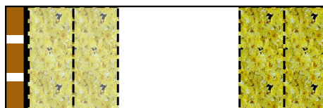
Abbildung 4.35: Schematischer Schichtaufbau zur Messung bei variabler Befüllung und Luftspalt mittig.
