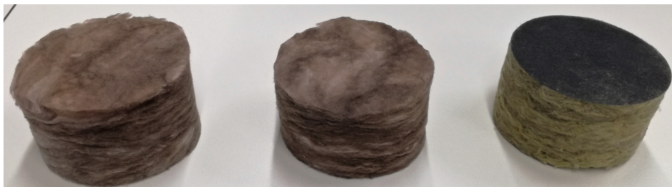
Abbildung 4.1: Impedanzrohrproben von links nach rechts: Akustik Board, Mineral Plus KP 034 und FPL 035-GVB.
