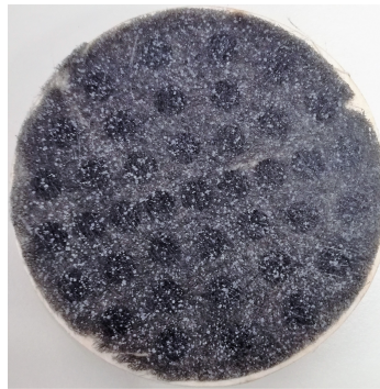
(b) Rückseite der Lochplatte mit Akustikvlies.
