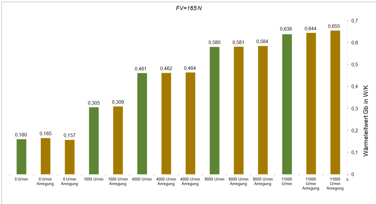
Abbildung 6.15: Wärmeleitwert unter Anregung bei unterschiedlichen Drehzahlen
