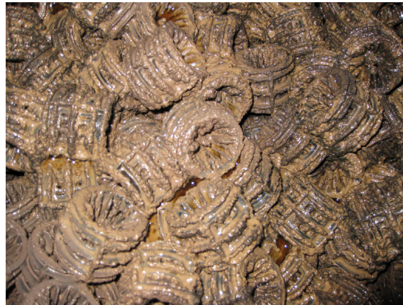
Abbildung 2.2: Immobilisierte Bakterien auf Füllkörpern in einem Rieselbettreaktor [22]
