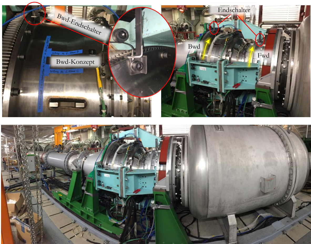
Abbildung 4.15: Fotoaufnahmen der Verlegungs- und Endschalterkonzepte am Bwd- und Fwd-Rig (oben) und vom fertig instrumentierten Prüfstand (unten).
