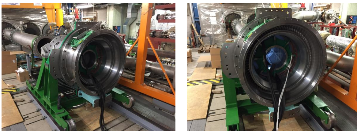
Abbildung 3.35: Fotoaufnahmen vom fertig montierten Aft Outer Casing am AnCa-Prüfstand.
