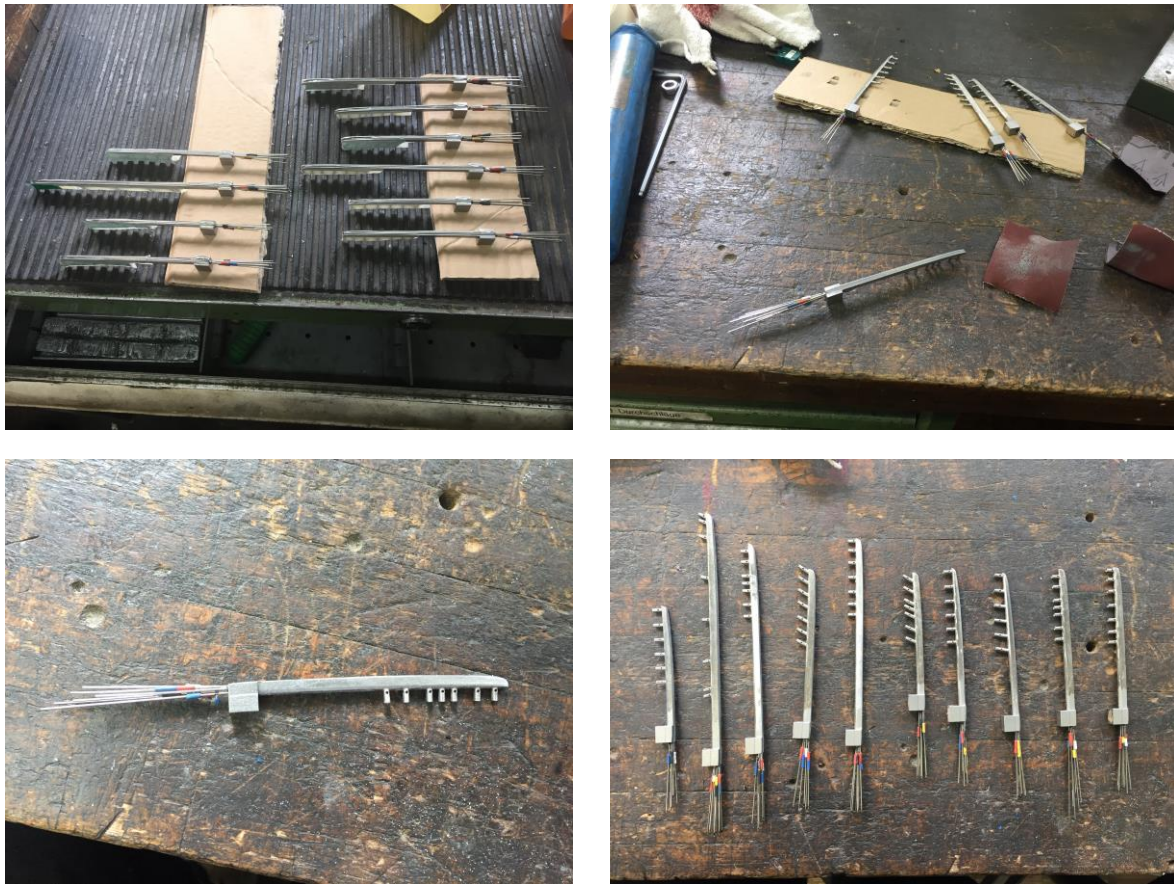
Abbildung 4.5: Fotoaufnahmen vom Einbetten der Pitot-Röhrchen in die Rakes mit Epoxydharz.
