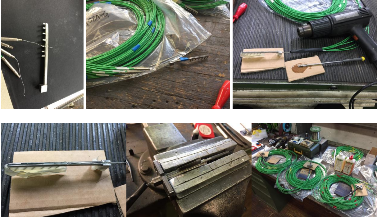
Abbildung 4.7: Ausgewählte Fotoaufnahmen von der Endfertigung der Temperaturrakes.
