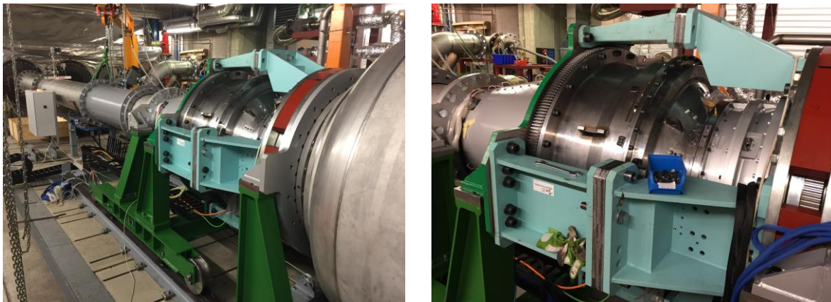
Abbildung 3.57: Geschlossener Prüfstand nach erfolgter Spaltkontrolle und Prüfstandsausrichtung.
