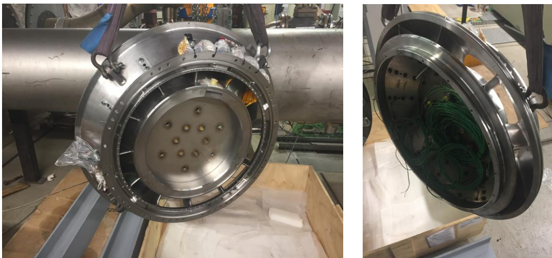
Abbildung 3.42: Turbinenübergangskanal im angelieferten Zustand.
