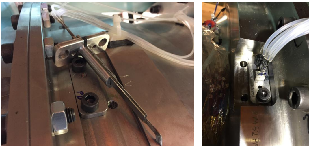
Abbildung 4.30: Instrumentierung des Grenzschichtkammes BLI48C in Messebene C.
