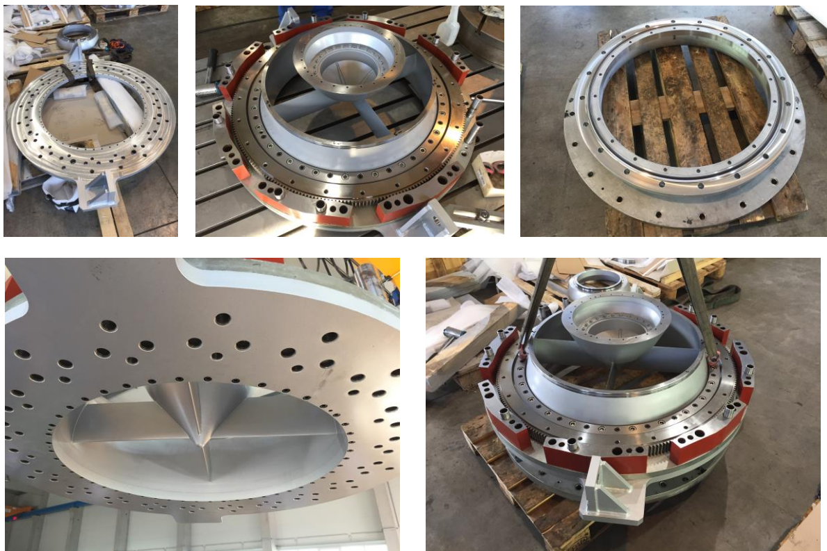
Abbildung 3.49: Fotostrecke mit Aufnahmen ausgewählter Montagestadien der Einlaufbaugruppe (AIDA-Drehvorrichtung und Neuteile) mitsamt Kammerübergang beim Fertigungsbetrieb vor Ort.
