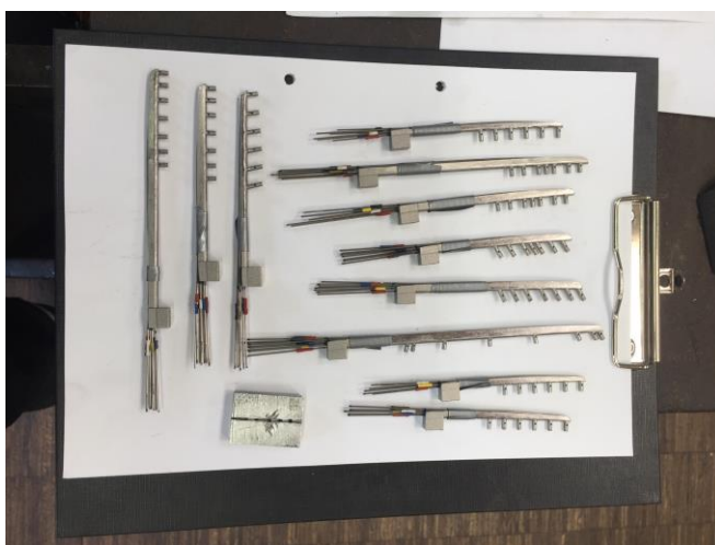
Abbildung 4.4: Fotoaufnahme der Totaldruckrakes mit den vorerst noch mittels Klebeband in Position gehaltenen Pitot-Röhrchen (links) und Schrumpfschlauch-Farbcode für Pitot-Röhrchen anhand der radialen Position im Ringraum (rechts).
