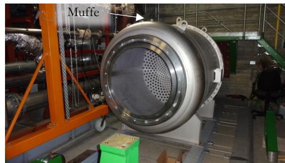
Abbildung 3.6: Einlaufkessel mit Lochscheibe zur Vergleichmäßigung der Strömung.
