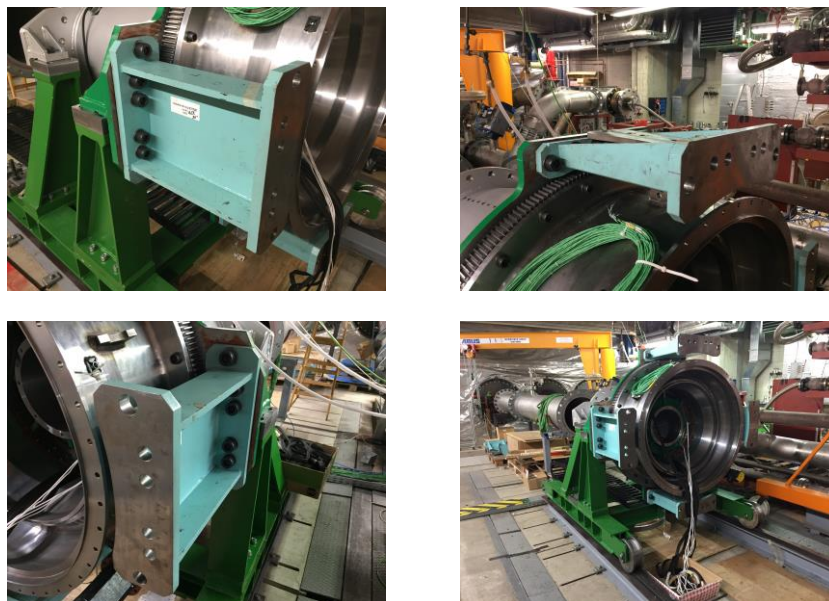
Abbildung 3.37: Fotoaufnahmen der fertig montierten Bwd-Beams bei ALF-90° (links oben), ALF-0° (rechts oben) und ALF-270° (links unten) sowie von allen vier Bwd-Beams gleichzeitig (rechts unten).
