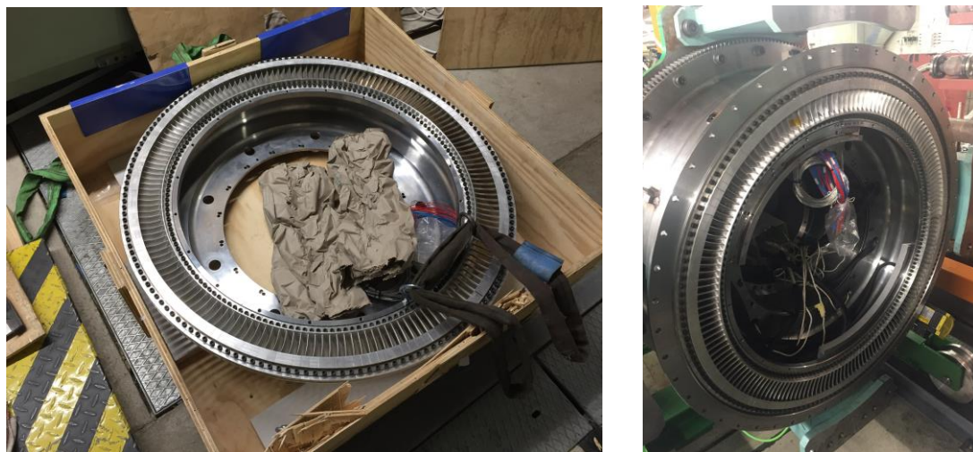
Abbildung 3.40: Fotoaufnahmen vom Niederdruckstator im angelieferten Zustand (links) und im bereits montierten Zustand (rechts).
