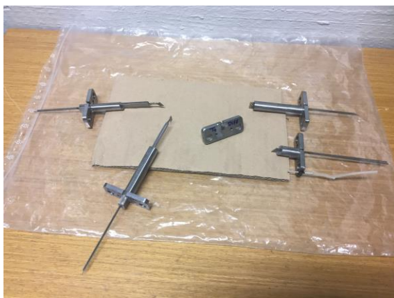
Abbildung 4.9: Fotoaufnahme von vier einbaufertigen Grenzsichtkämmen (links) und Schema für Positionscode bzw. optionalen Farbcode (rechts).
