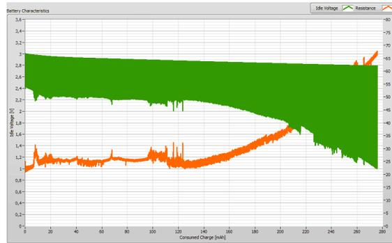
Abbildung 6.10: Entladekurven mit deutlichem “Rauschen” bei einem verschweißten 1S2P Batteriepack mit Steckverbinder
