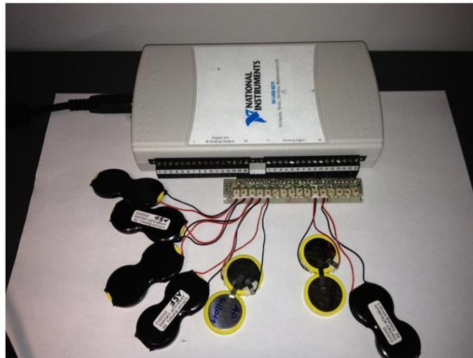
Abbildung 3.9: Erstes 16-Kanal Konstantentladesystem mit Spannungslogger
