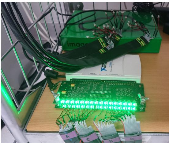
Abbildung 5.11: Pulsentladestation im Betrieb mit CR2450-Einzelfixtures
