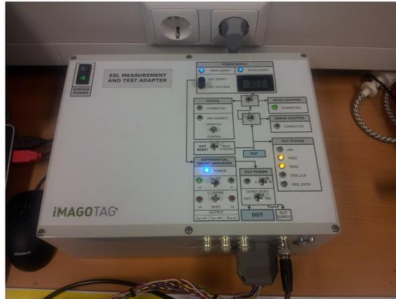
Abbildung 1.7: Automatisiertes Messsystem zur Erfassung des Energieverbrauchs von ESLs [4]
