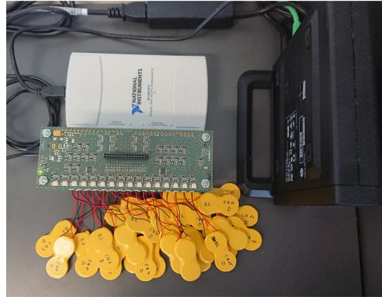
Abbildung 5.10: Konstantentladestation mit NI USB-6211 und Steuerrechner
