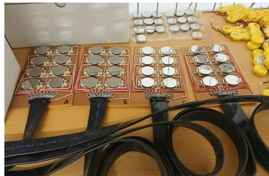
Abbildung 5.12: CR2450-Testadapter für Einzelzellen, an die Pulsentladestation angeschlossen
