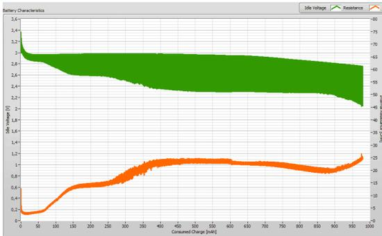
Abbildung 6.8: Entladekurven mit deutlichen Stufen und Plateaus
