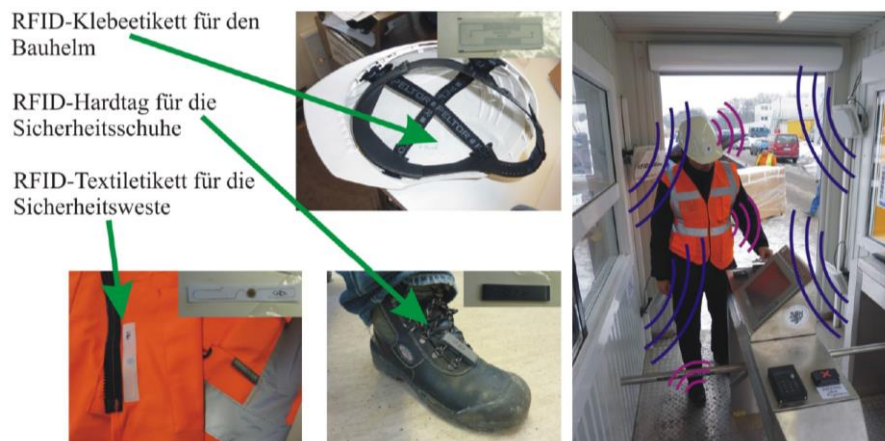
Abbildung 2-24: PSA-Kontrolle mittels RFID 115
