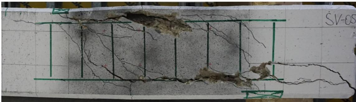
Abb. 4.30.: Detailrissbild von SV-05 mit eingezeichneter Bewehrung an der Rückseite
