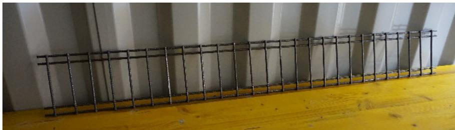
Abb. 3.5.: Durchstanzelement im ungebogenen Zustand
