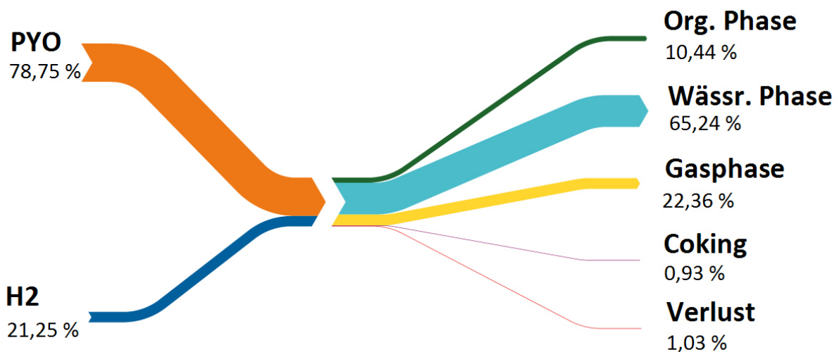
Abbildung 23) Massenbilanz, Gegenüberstellung Ein- und Ausgangsströme (Beispiel PYO 300 )
