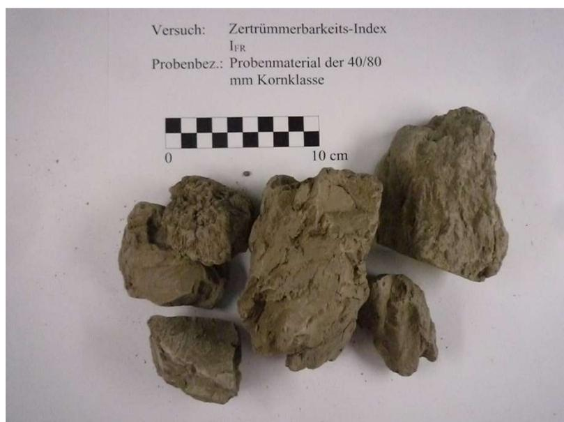
**Abb. 10:** (Getrocknetes) Probenmaterial der 40/80 mm-Kornklasse
