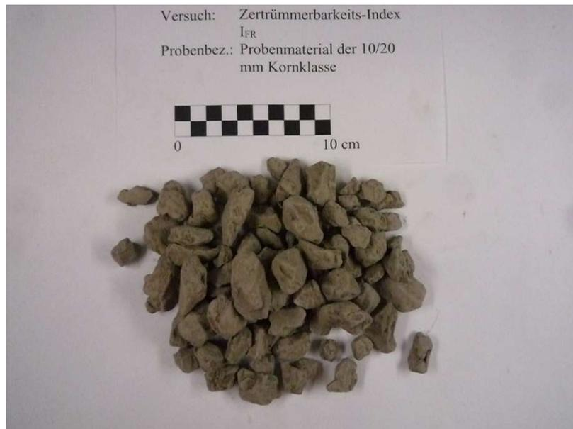
**Abb. 9:** (Getrocknetes) Probenmaterial der 10/20 mm-Kornklasse
