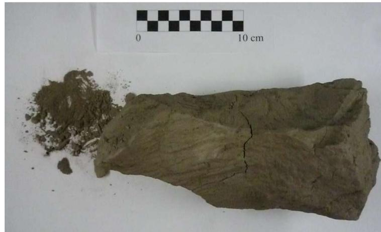
**Abb. 15:** Probestück und davon abgelöste Fragmente nach der Lagerung unter Wasserbedeckung und anschließender Trocknung
