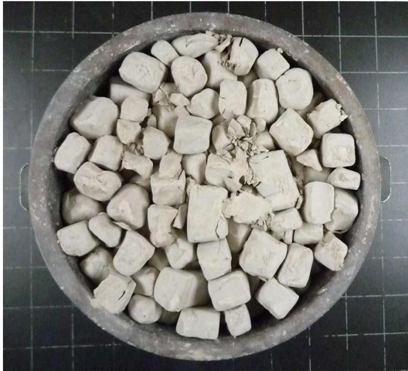
**Abb. 7:** Unterseite des Proctortopfes. Es ist nahezu keine Zertrümmerung vorhanden.
