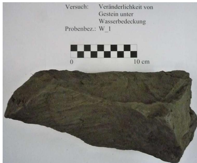
**Abb. 14:** Probenmaterial für die Lagerung unter Wasserbedeckung
