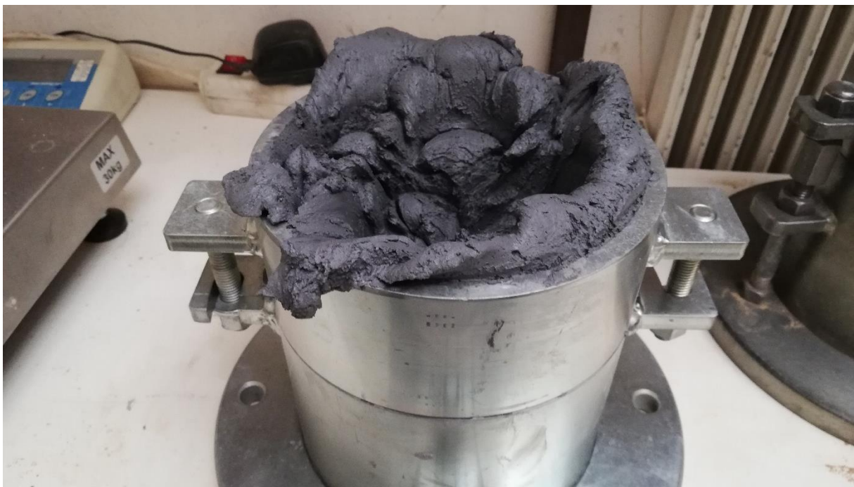
Abb. 16: Einbau mit Proctorhammer der Tonprobe S
