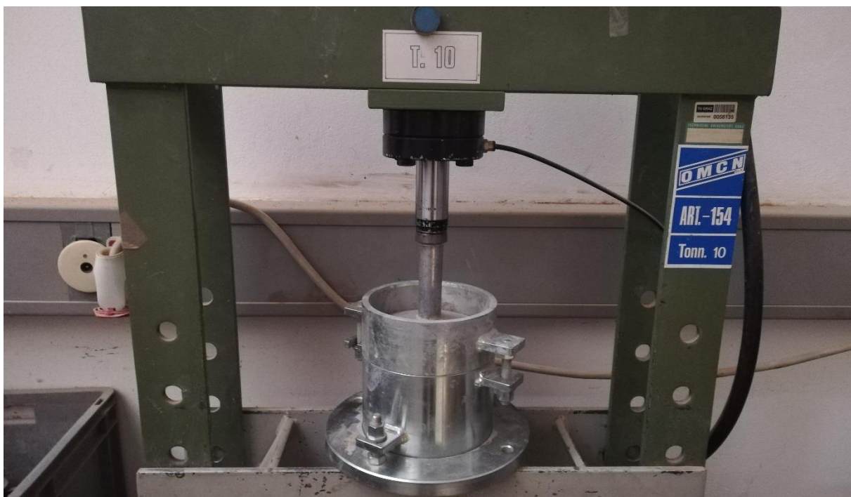
Abb. 15: Verdichten mit Hydraulikpresse der Bodenprobe S
