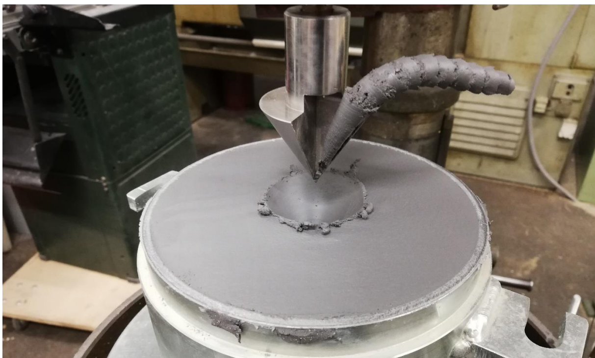
Abb. 19: Kegelförmige Vertiefung in der Bodenprobe S bei weichem Boden
