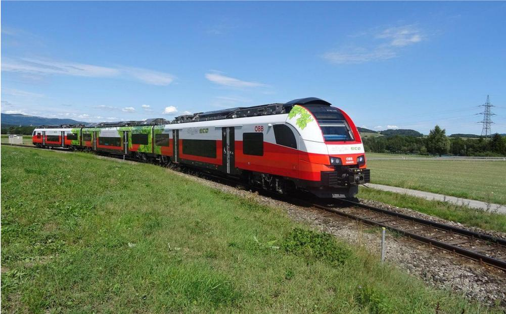
Abbildung 4-1: ÖBB City Jet Eco im Betrieb ohne Oberleitung Quelle: ÖBB[14]
