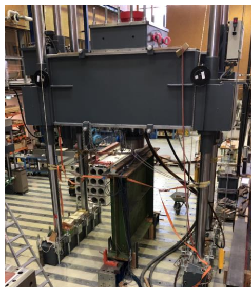
Abbildung 3.5: 4 MN Prüfstand am LKI
