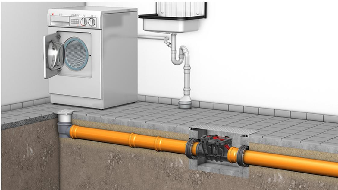
Abbildung 51: Rückstauklappe in Kellerraum für Grauwasser
