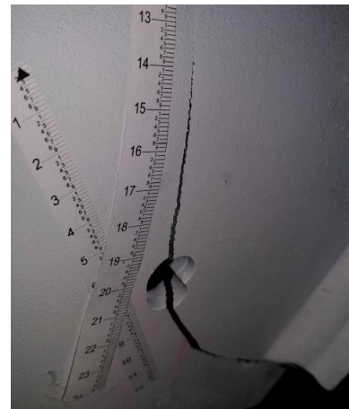
Abbildung 5.12 Finaler Riss als Folge der Schwingprüfung, [20]
