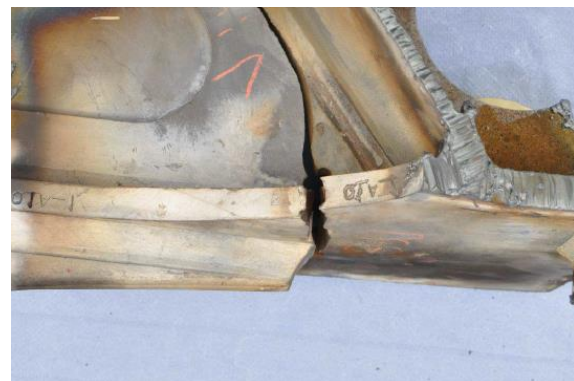
Abbildung 5.9 Durchführung des Schwingversuches bis zum Durchbruch, [19]
