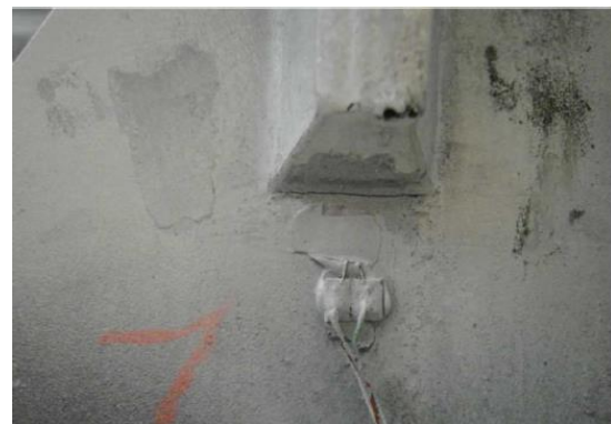
Abbildung 5.8 Anriss beim Schwingversuch am ICx Rahmen, [19]
