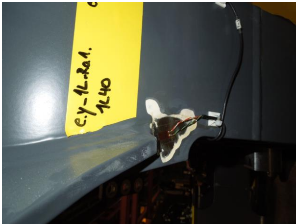
Abbildung 6.7 DMS-Positionen, Abbinder am Untergurt Langträger, SF100L, [25]
