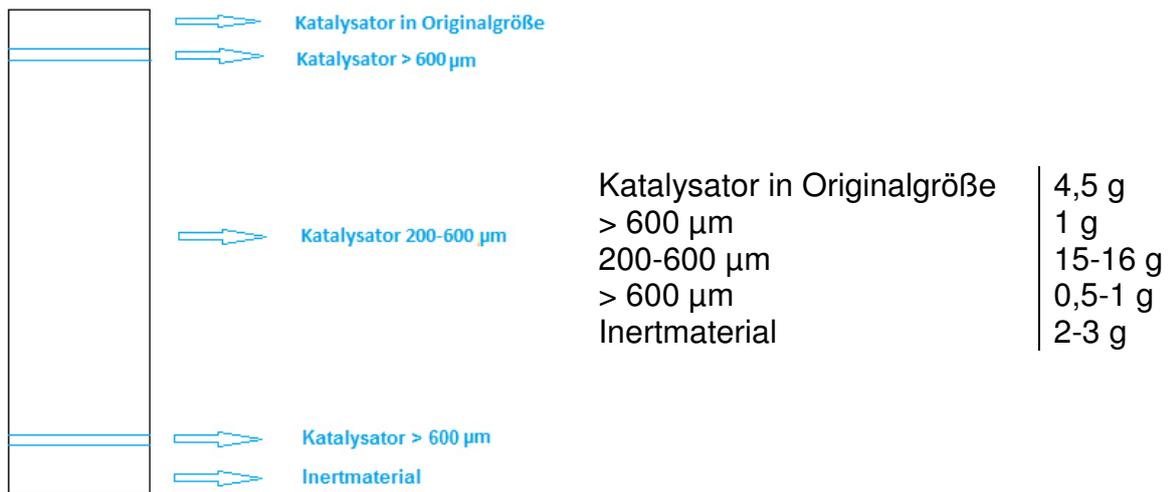
Abb 3-6 Schichtung des Katalysators im Reaktor und Einwaagen der Katalysatorfraktionen
