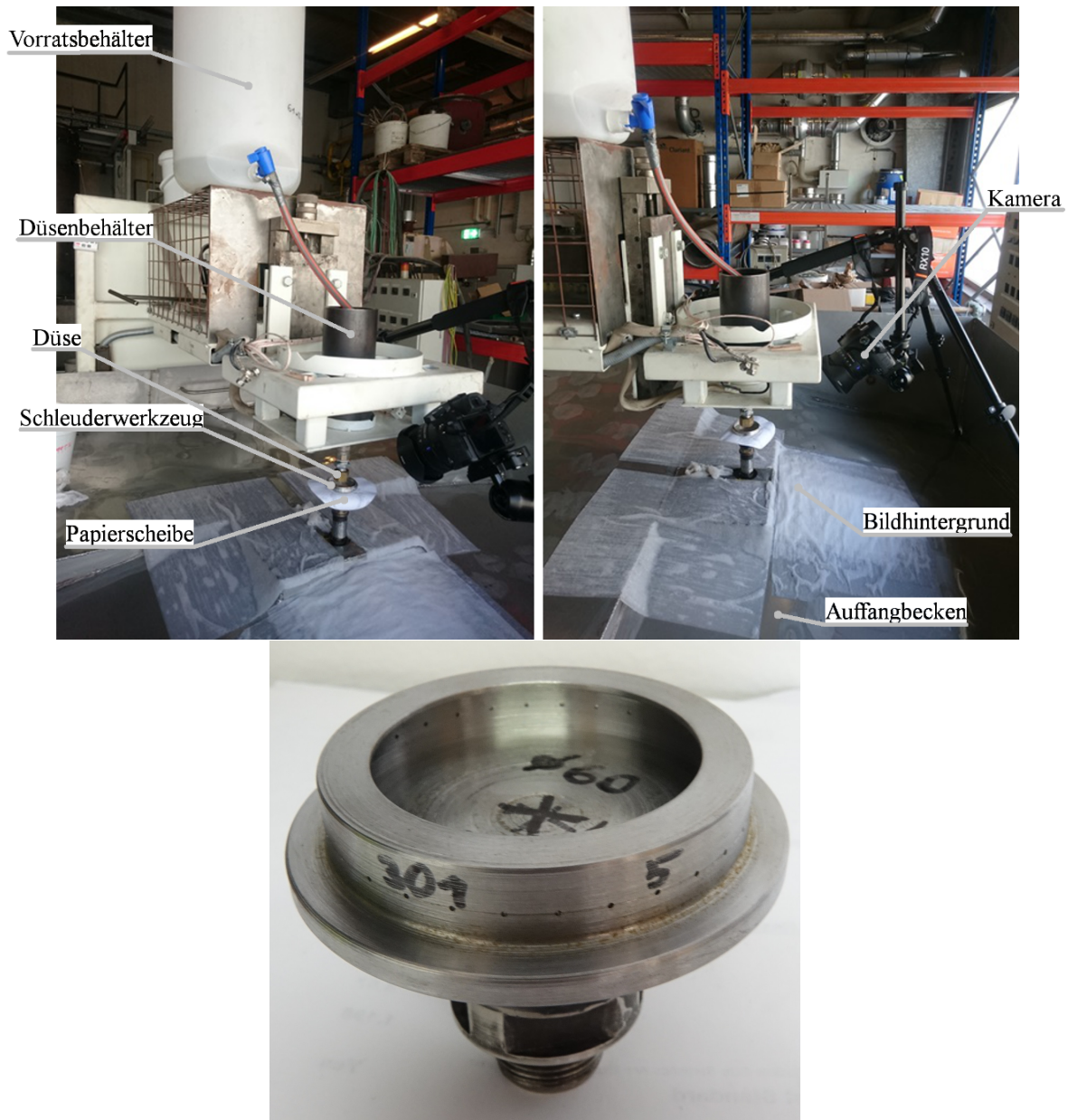
Abb. 5-1: Bilder der Technikumsanlage und der eingespannten Schleudertrommel, unteres Bild : Schleudertrommel aus Stahl für die Versuche an der Technikumsanlage
