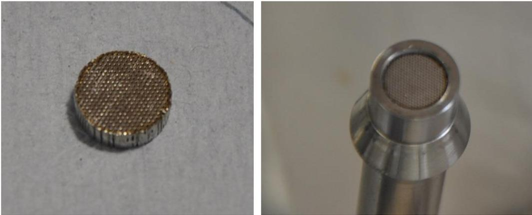
Abb. 5-7: Metallsieb zur Versiegelung des Katalysatorbettes
