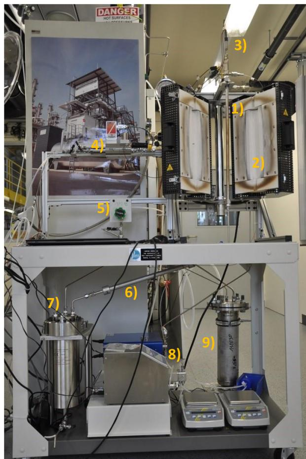
Abb. 5-1: Aufbau der Versuchsanlage: 1) Rohrreaktor, 2) Heizmantel, 3) Thermosensor, 4) Massendurchflussregler, 5) Druckminderventil, 6) Gegenstromkühler, 7) Produktsammelbehälter, 8) Hochdruckpumpe, 9) Expansionsbehälter
