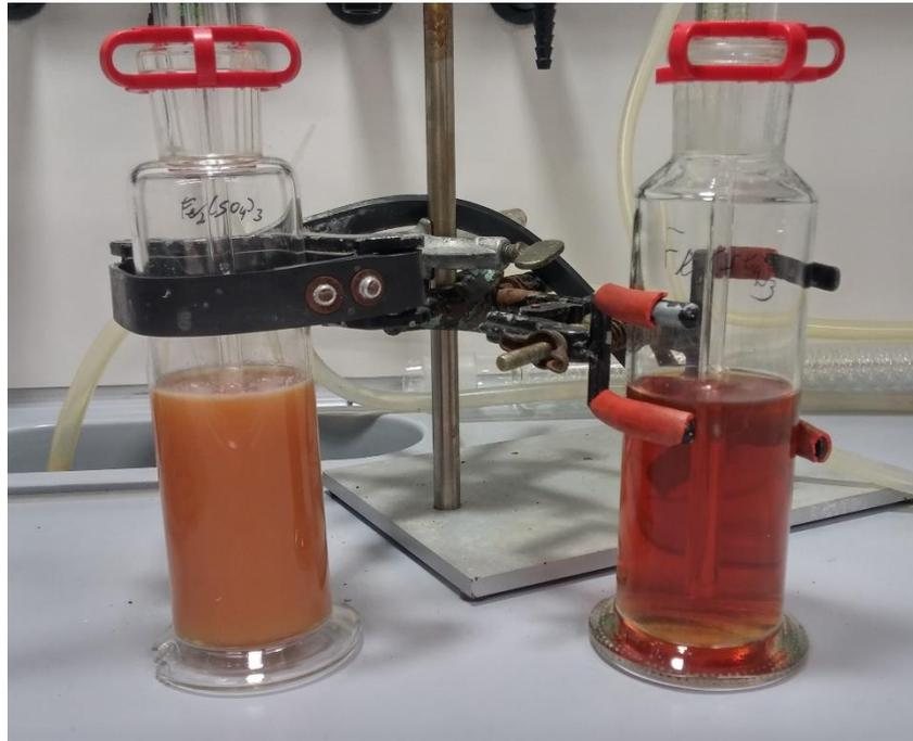
Abb. 5-14: Eisen(III)sulfat-Lösungen während des Versuchs. links: Fällung von FeS ist bereits zu sehen; rechts: noch keine FeS-Fällung, das gesamte H<sub>2</sub>S wird in der ersten Flasche ausgewaschen
