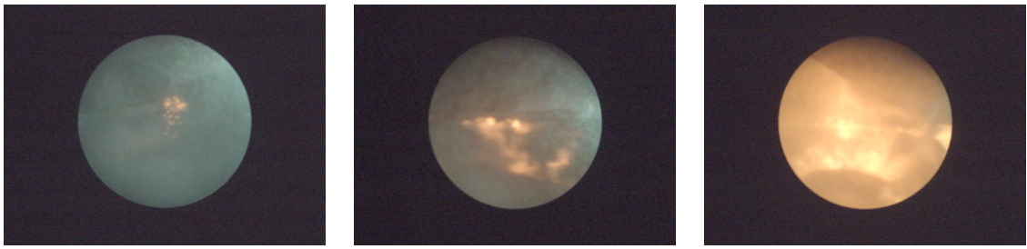
Abbildung 5.11.: Optische Analyse der Dual Fuel Verbrennung; Die Bilder zeigen den MFB50 mit unterschiedlichen Benzinanteilen. 1200 \text{ min}^{-1}/p_i = 10 \text{ bar} , \text{AGR rate} = 35 \% , \lambda_g = 1.12 , p_{\text{Rail}} = 1100 \text{ bar} ; Links: x_{\text{Benzin}} = 80 \% , \text{SOI} = 22^\circ \text{KW v. OT} , \text{MFB50} = 16^\circ \text{KW n. OT} Mitte: x_{\text{Benzin}} = 60 \% , \text{SOI} = 18^\circ \text{KW v. OT} , \text{MFB50} = 15^\circ \text{KW n. OT} Rechts: x_{\text{Benzin}} = 45 \% , \text{SOI} = 16^\circ \text{KW v. OT} , \text{MFB50} = 14^\circ \text{KW n. OT}
