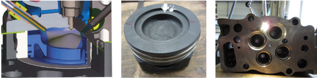
Abbildung 2.3.: Aufbau des optischen Zuganges; Links: Schematische Darstellung (Quelle: AVL) | Mitte: Bearbeitung am Kolben | Rechts: Zylinderkopf mit Endoskop und Beleuchtungszugang
