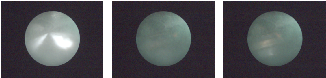
Abbildung 5.12.: Optische Analyse der Dual Fuel Verbrennung; Die Bilder zeigen unterschiedliche Phasen des Brennverfahrens. 1200 \text{ min}^{-1}/p_i = 10 \text{ bar} , \text{AGR rate} = 35 \% , \lambda_g = 1.12 , p_{\text{Rail}} = 1100 \text{ bar} , x_{\text{Benzin}} = 80 \% ; Links: \varphi = 11^\circ \text{KW v. OT} , \text{EOI} Mitte: \varphi = 8^\circ \text{KW n. OT} , \text{MFB10} Rechts: \varphi = 46^\circ \text{KW n. OT} , \text{MFB90}
