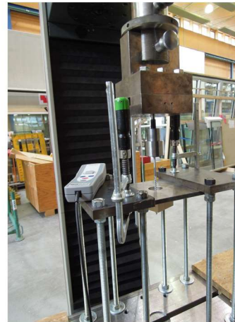
Abbildung 118: Prüfgerät für Ermittlung von Eindrehmoment (Eindrehprüfer) und Ausziehtragfähigkeit (Zwick)
