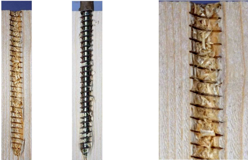
Abbildung 73: Probekörper und Schraubkanal nach Applizierung in Faserrichtung, mit Vorbohren
