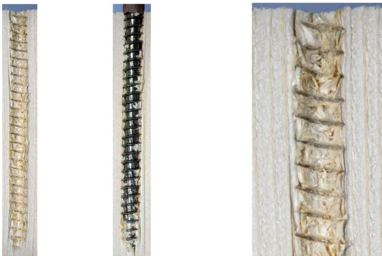
Abbildung 74: Probekörper und Schraubkanal nach Applizierung in Faserrichtung, ohne Vorbohren
