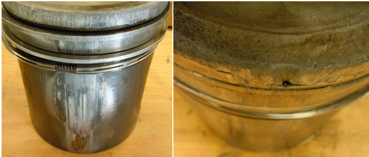
Abbildung 2.10: Motorschaden - Beispiel Anreiben Kolben
