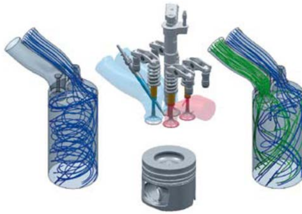
Abbildung 4.2: geschlossene (links) und geöffnete (rechts) Drallklappe [16]
