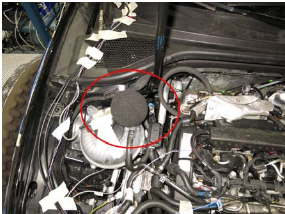
Abb. 5.4: Mikrophon im Motorraum
