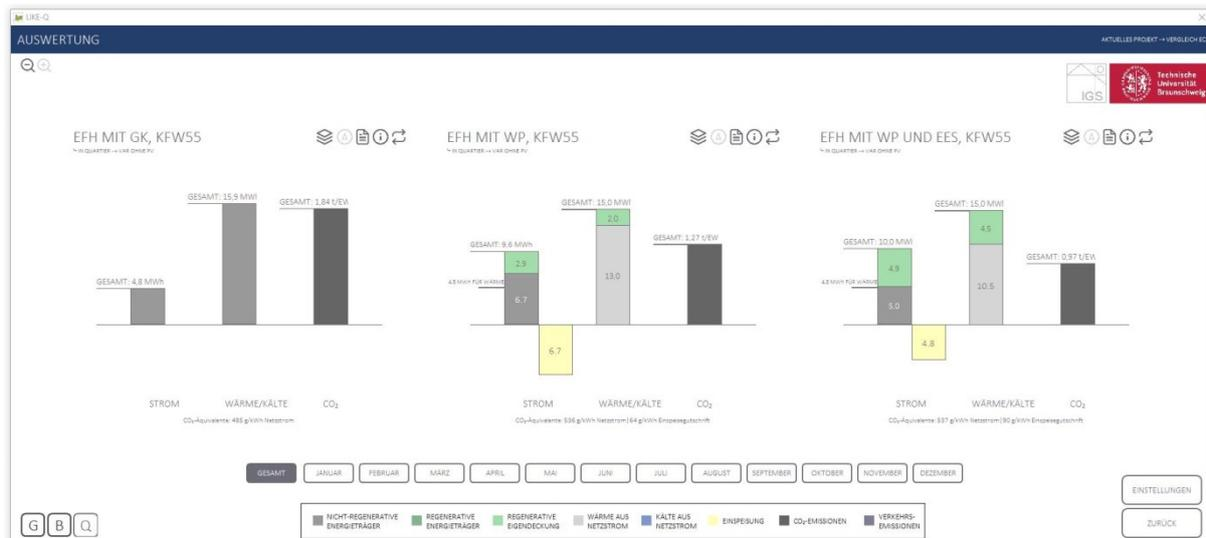
Abbildung 2: Ergebnisseite von LIKE-Q. In Balkendiagrammen werden Endenergiebedarfe für Strom und Wärme sowie die personenbezogenen CO<sub>2</sub>-Emissionen für bis zu drei Objekte angezeigt, sodass sich verschiedene Konzepte schnell vergleichen lassen.
