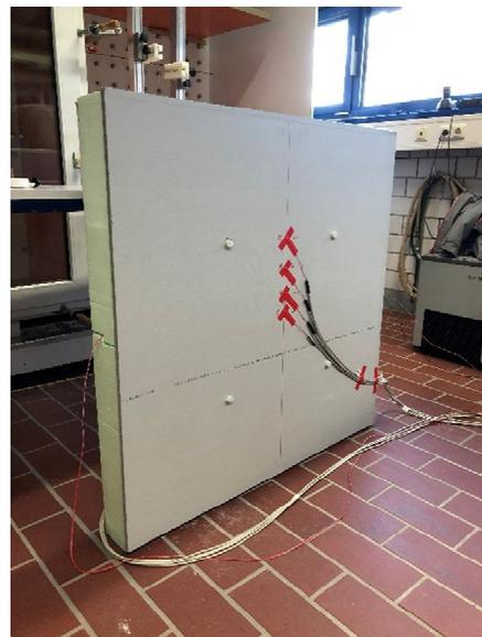
Abbildung 3: verkleideter Prüfkörper der Leichtbaukonstruktion der Versuchsreihe 2
