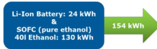
Abbildung B-8: Zur Verfügung stehender elektrischer Energiespeicher [23]
