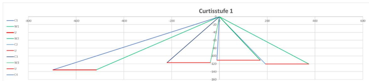
Bild 10-9 Geschwindigkeitsdreieck Stufe 1, Verlustbehaftet
