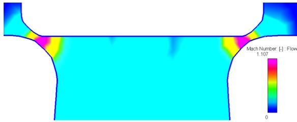
Bild 8-43 Schnittansicht - Detail Ventil 2, Mach-Zahl, Pos I
