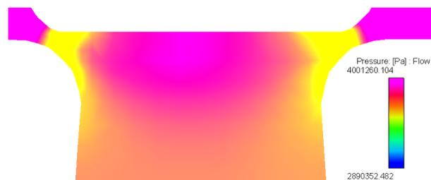
Bild 8-42 Schnittansicht - Detail Ventil 2, Druck, Pos II
