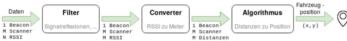
Abbildung 3.9: Die Positionsberechnung erfolgt in drei Schritten: Zuerst werden die Daten gefiltert, danach werden die Signalstärken zu einer Distanz umgerechnet und anschließend werden sie dem Algorithmus übergeben, welcher dann die Position berechnet.
