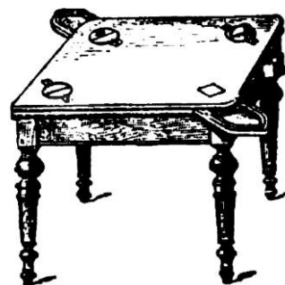
Abbildung 36: G. Colditz: Spieltisch mit gegenüberliegenden ausklappbaren Brettchen zum Auflegen von Gläsern oder Zigarren. Zusätzlich sind in den Tisch Kästchen eingearbeitet, die als "Geldnäpfchen", Zündholzbehälter oder Aschenbecher dienen, Zeichnung, aus Uhlands Industrie Rundschau 1887
