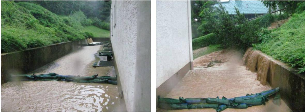
Abbildung 9a und 9b zeigen die realen Abflüsse zugehörig zu Abbildung 6, wo mit der gleichen Regenmenge wie beim dokumentierten Ereignis gerechnet wurde. Ebenfalls gut zu sehen: Die Zuflussstellen zum Gebäude sind in der Realität und bei der Berechnung übereinstimmend. Ebenfalls sehr oft in der Realität zu finden: Ebenerdige Lichtschächte an der hangzugewandten Seite, welche perfekte Wassereintrittsstellen ins Gebäude darstellen. (Quelle der Bilder: © FF Laakirchen/EPZ)
