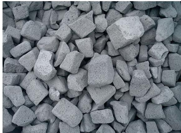
Abbildung 4 Schaumglasschotter als lastabtragende Wärmedämmung kann nur bei einer Feuchtebeanspruchung nach Teil 4 der DIN 18195 eingebaut werden.
