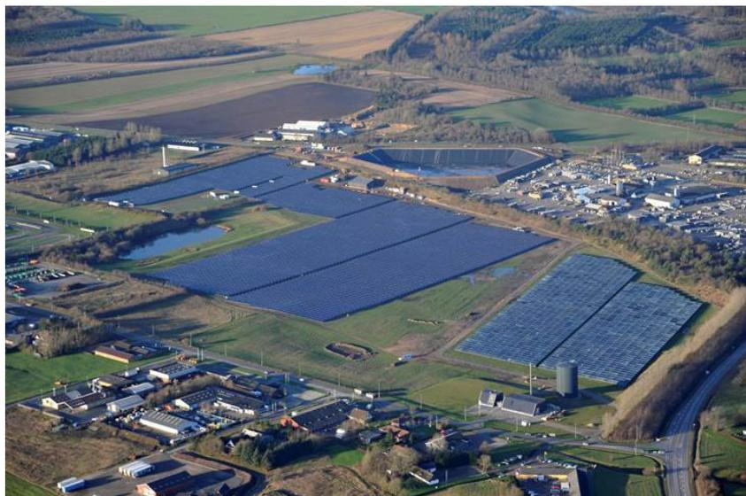
Abbildung 3 Luftbild Anlage Vojens, 70.000 m<sup>2</sup> Kollektorfläche, 207.000 m<sup>3</sup> Speichervolumen
