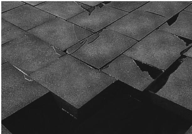
Abbildung 3 Schaumglasplatten als lastabtragende Wärmedämmung können im drückenden Wasser (nach DIN 18195, Teil 6) angeordnet werden.
