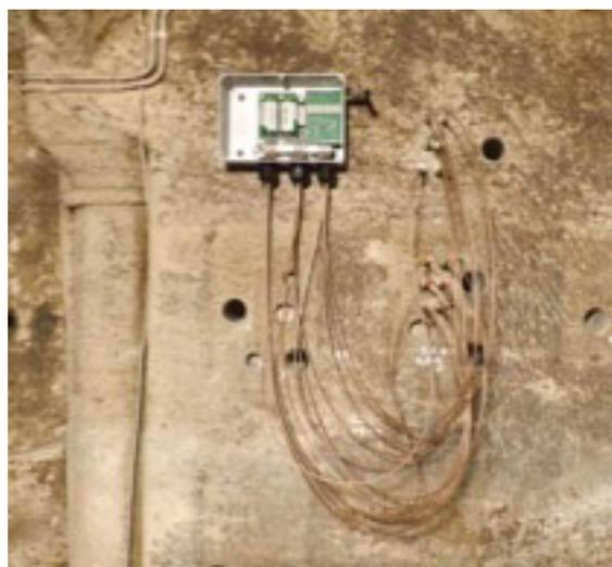
Abbildung 2 Drahtloser Sensorknoten zur Materialfeuchtebestimmung mittels elektr. Impedanzspektroskopie
