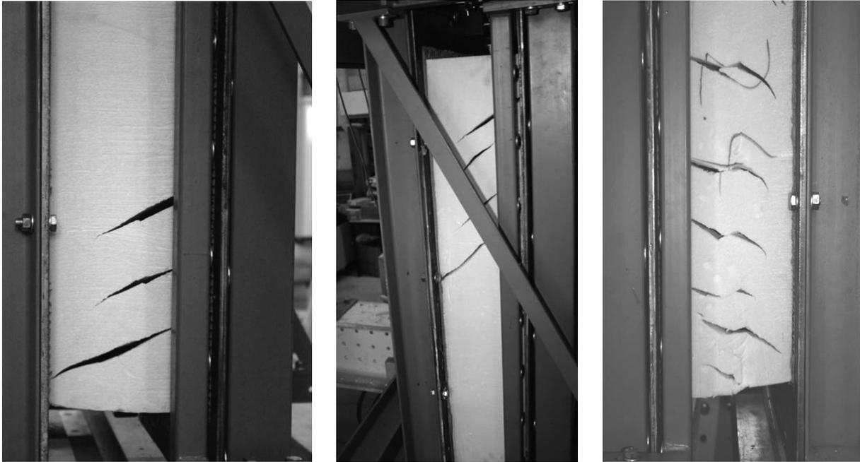
Abbildung 11 Probekörper nach dem Schubversagen
