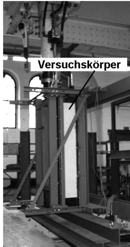
Abbildung 9 Kurzzeitversuche zur Bestimmung des Schubtragverhaltens von lastabtragenden Wärmedämmplatten.
