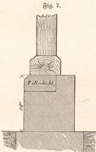
diesem Falle sind jedoch Formsteine zur Kollschicht zu verwenden, indem durch den Verbau der Steine die beim Brennen erhaltene Kruste verloren gehen würde.
