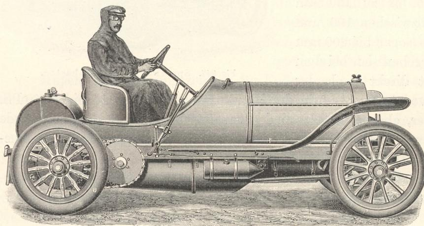
Fig. 950. Mercedes-Gordon-Bennett-Wagen mit 120pferdigem Vierzylindermotor.
