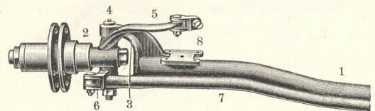
Fig. 926. Halbe Vorderradachse.
