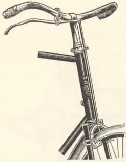
Fig. 899. Vorderrad-Felgenbremse.
