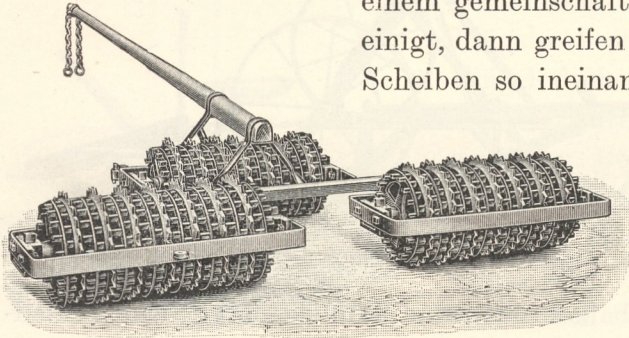
Fig. 799. Dreiteilige vereinigte Cambridge-Croskill-Walze von Fr. Dehne, Halberstadt.
