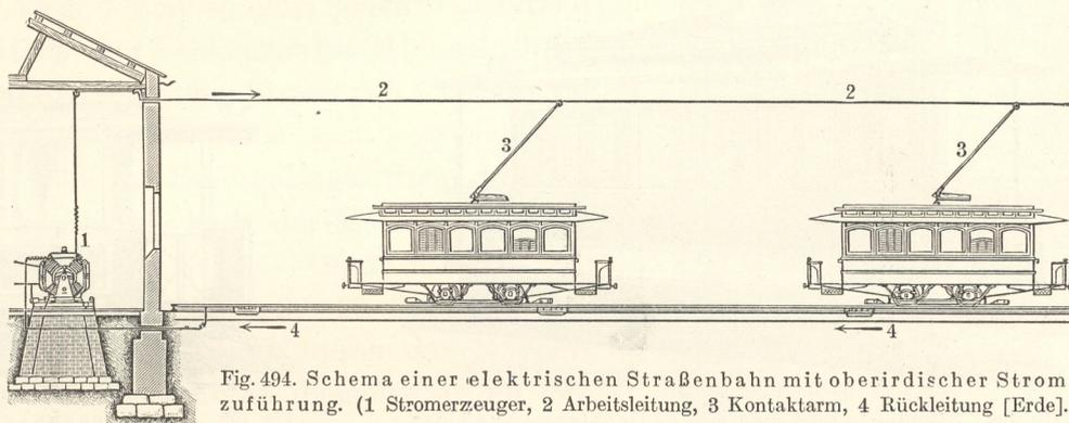
Fig. 494. Schema einer elektrischen Straßenbahn mit oberirdischer Stromzuführung. (1 Stromerzeuger, 2 Arbeitsleitung, 3 Kontaktarm, 4 Rückleitung [Erde].)
