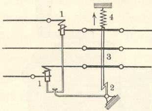
Fig. 427. \* Schaltschema eines dreipoligen Maximalölschalters.
