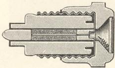
Fig. 429. Schnitt durch eine durchgebrannte Patrone mit Stöpselkopf.
