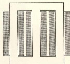
Fig. 390. Drehstromtransformator (Anordnung 1).
