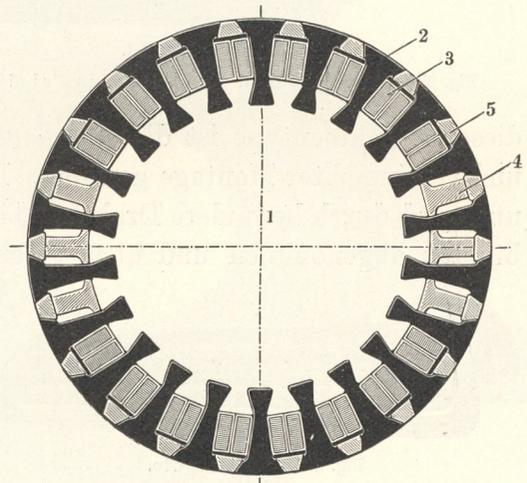
Fig. 358. Zweipoliger Rotor eines Drehstrom-Turbogenerators im Querschnitt.
