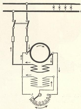
Fig. 329. Schaltungsschema der Compoundmaschine.
