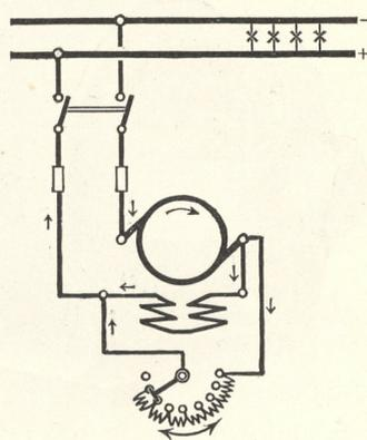
Fig. 330. Schaltungsschema der Hauptstrommaschine.
