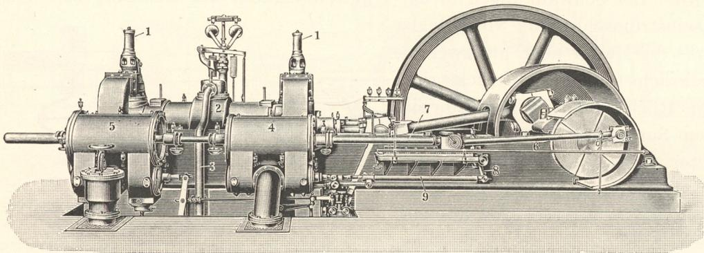
Fig. 275. Körtings Zweitaktmaschine (Nennleistung 500 PS bei 125 Umdrehungen).
