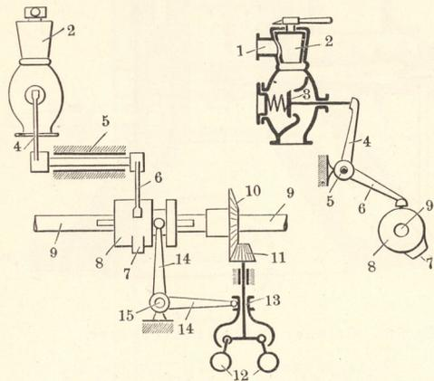
Fig. 219 und 220. Nockensteuerung des Einlaßventils und Aussetzerregulierung.
