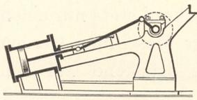
Fig. 147. Schrägliegende Dampfmaschine.
