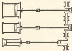
Fig. 148. Dreifach-Expansionsmaschine. (Drei um  $120^\circ$  gegeneinander versetzte Kurbeln.)
