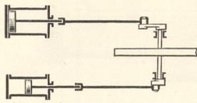
Fig. 146. Verbundmaschine.
